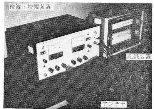
図 18. テレメーターリングカプセルの各種装置
